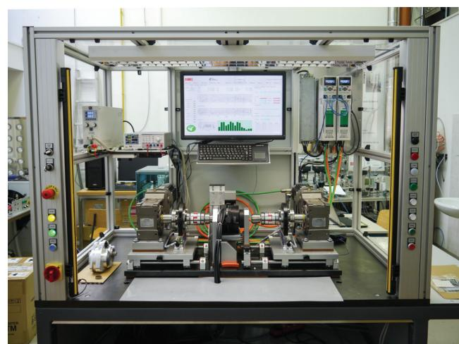
Slika 4: Diagnostični sistem za končno kontrolo elektromotornih pogonov za kolesa tipa Pedelec
