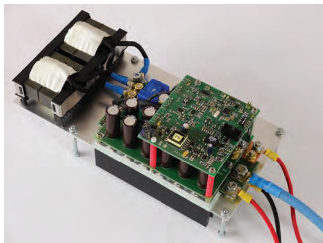
Slika 4: DC/DC-pretvornik za pomožne napajalne sisteme na osnovi gorivnih celic
