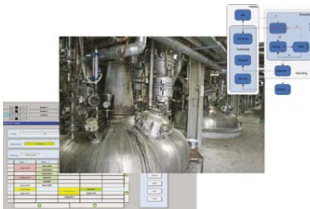
Slika 5: Vodenje šaržnega procesa sinteze smol v podjetju Color na osnovi orodja PLCbatch
