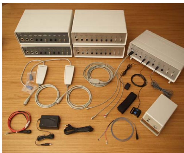
Slika 4: Sistem za merjenje fizioloških veličin: EKG, EEG, dihanje, tlak krvi, merjen na prstu, temperatura, prevodnost kože ter pomožne veličine
