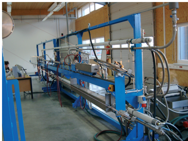
Slika 2: Sistem za vodenje naprave za obdelavo žice z magnetno zgoščeno plazmo
