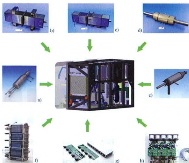
Slika 1: Prikaz pomembnih gradnikov sistema: a) avtotermni reformer, b) razzvepljevalnik, c) reaktor za vodno-plinsko pretvorbo, d) PrOx, e) katalitski gorilnik, f) sklad z gorivnimi celicami, g) namenski krmilnik in h) DC/DC pretvornik.
