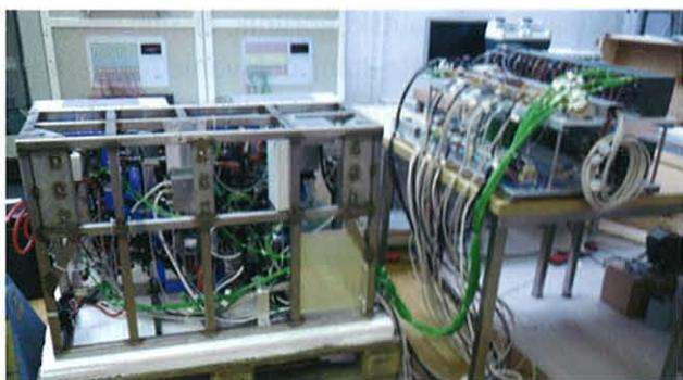
Slika 4: Procesor goriva z BoP komponentami v fazi testiranja s Simatic krmilnikom.
