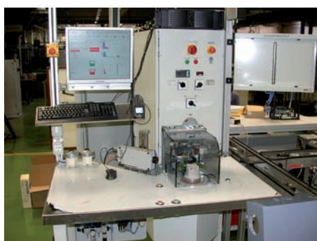
Slika 3: Diagnostični sistem za končno kontrolo elektromotorjev na novi proizvodni liniji ekomotorjev v Domelu
